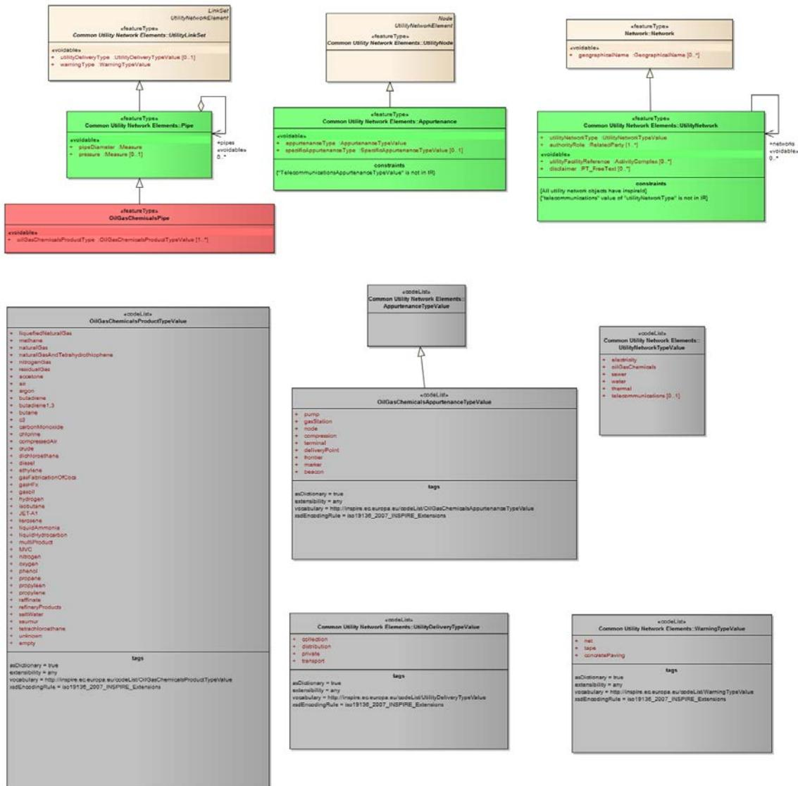
Figura 8: Diagrama de clases UML de Oil-Gas-Chemicals Networks de INSPIRE.
