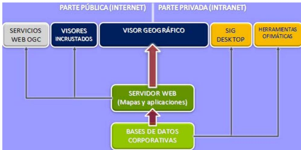
*Figura 3. Esquema de la arquitectura de las aplicaciones y servicios montados para ofrecer información a los usuarios*
