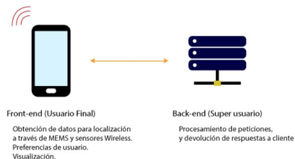
Figura 3: Componentes de la arquitectura básica del sistema de localización.
