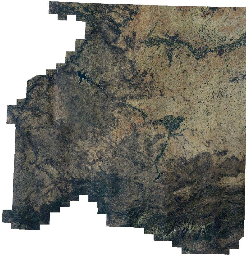
Figura 6. Aspecto visual de todo el bloque tras el equilibrado radiométrico.
