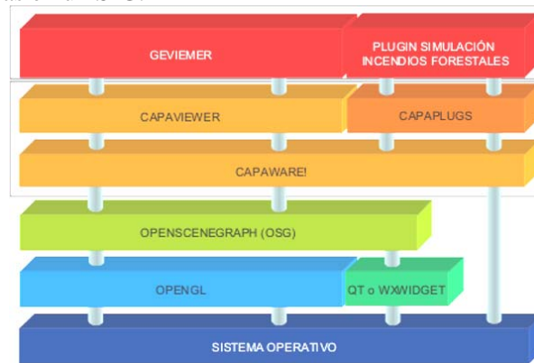
Figura 1. Arquitectura basada en capas
